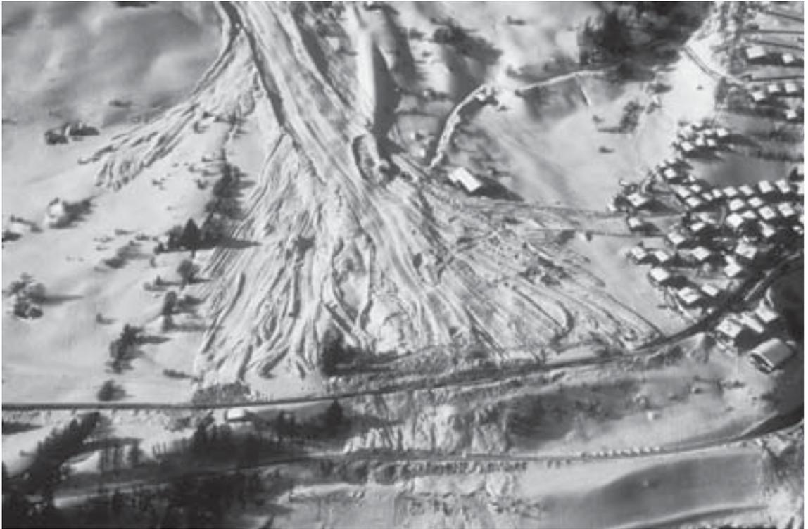
Abb. 6.55: Blitzingen, Goms, VS einige Tage nach dem letzten Lawinenabgang. Die Leitdämme waren hinterfüllt und weitgehend wirkungslos. Ein Damm wird bergseitig mit Schnee erhöht, um weitere Lawinen vom Dorf fernzuhalten. Die Strasse und die Bahnlinie werden gerade freigelegt. Foto: Lawinenwarndienst Goms, 26.2.1999.
