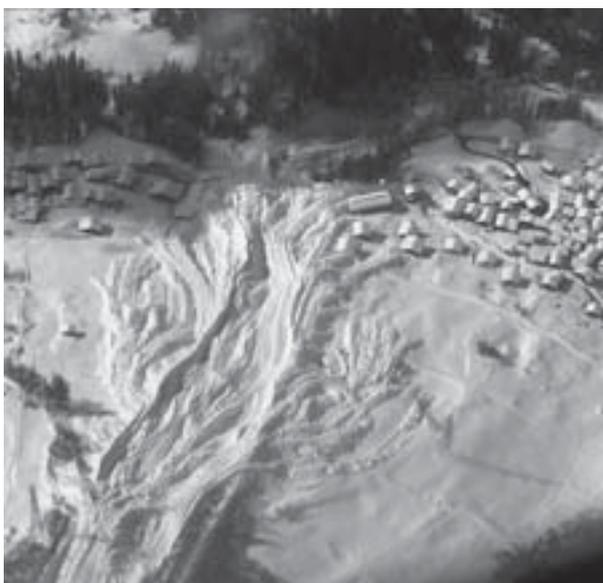
Abb. 6.40: Ablagerung der Fließlawine am Dorfrand von Lourtier, VS. Die Ablenkdamme sind gefüllt und wurden überflossen. 5 Lawinen sind im Verlauf des Februar niedergegangen und das gesamte potenzielle Anrissgebiet hat sich mindestens ein Mal entleert. Foto: SLF/M. Bründl, 26.2.1999.
