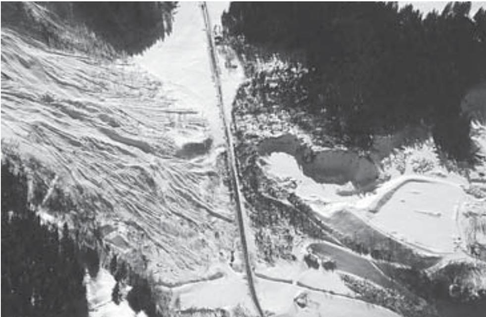
Abb. 6.7: Ablagerungsgebiet der Biralauri bei Mitholz/Kandersteg, BE. Nach 2000 wurde im Gebiet der auf dem Bild bereits geräumten Strasse ein Tagbautunnel erstellt, der nach zwei Jahren wegen Unterdimensionierung bereits wieder gesperrt und saniert werden musste. Foto: SLF/S. Margreth, 25. 2. 1999.
