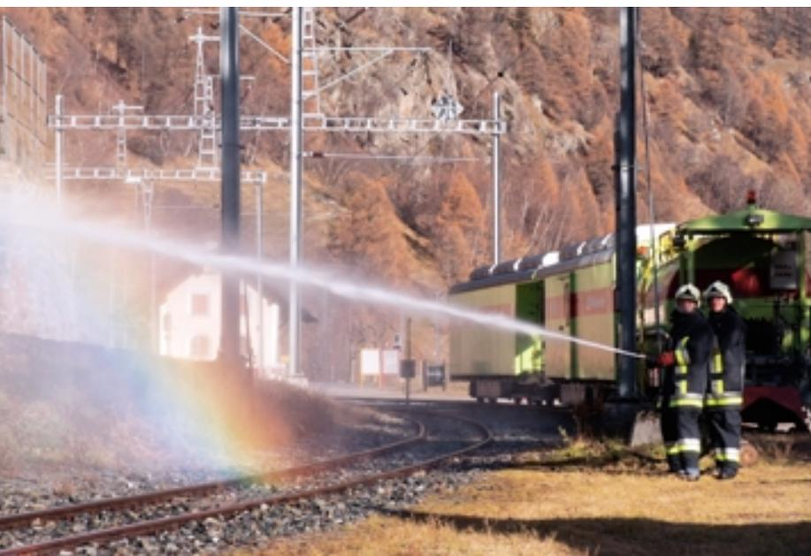
**Wasser marsch! Löschübung mit dem so genannten Schnellangriff des LöReZ. Dieser kann sofort eingesetzt werden, weil das vorgängige Schlauchverlegen entfällt, da sich dessen Schlauch auf einer am Zug angebrachten Rolle befindet. Das aus dem Strahlrohr schießende Wasser wird der Zisterne entnommen.**
