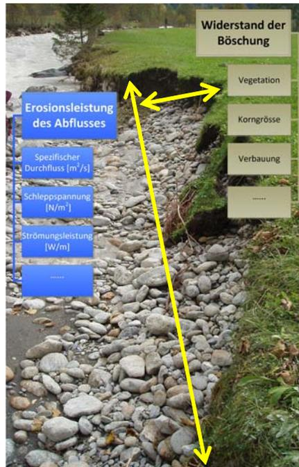
Abb. 1: Auswahl der erhobenen Parameter sowie Erosionslänge und -breite an der Weissen Lüttschine 2011
