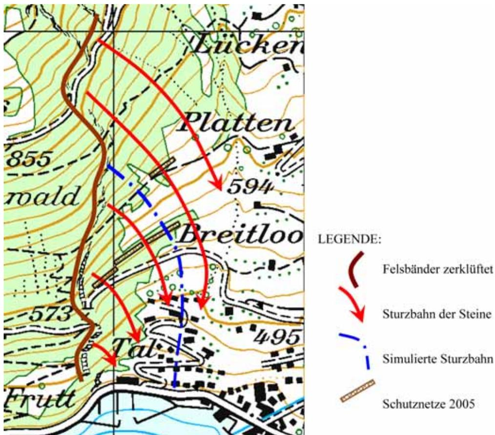
Abb. 7.1: Sturzbahnen der Steine und Lage der Schutznetze im Gebiet Tal.
